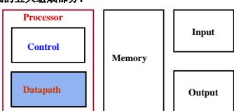
Processor (包含Control和Datapath)、Memory、Input、Output。
