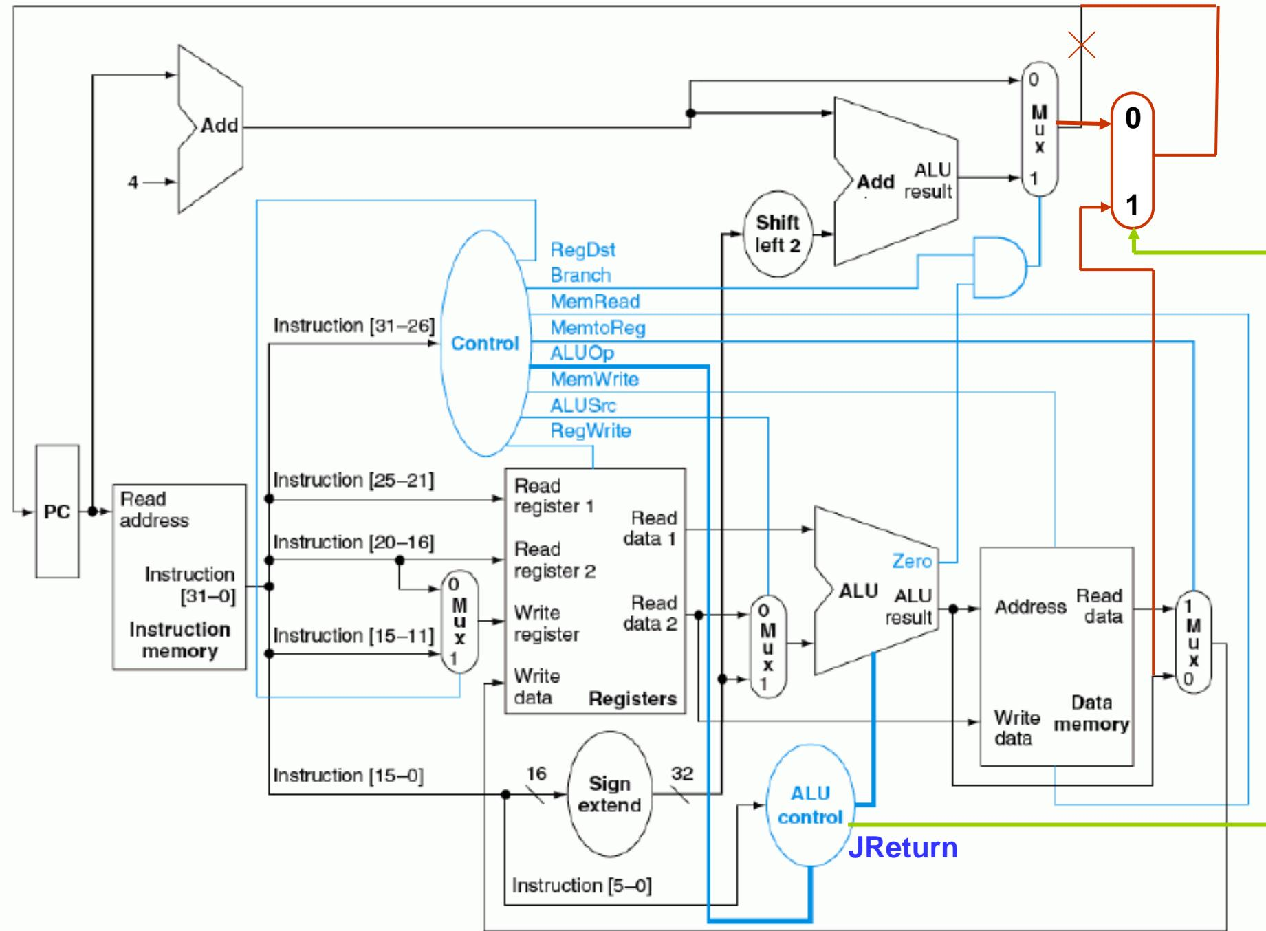
根据书中图5-12可以得到以下图5-13，在此基础上再加上Jr指令的控制信号
